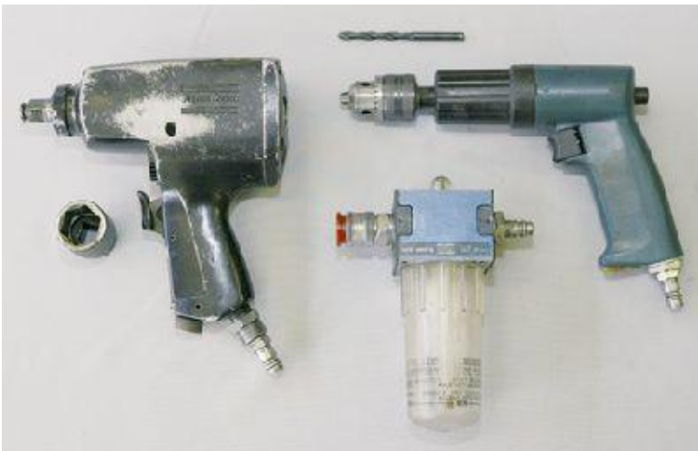
Figuur 14-13: Voor het gebruik van de slagmoersleutel en de boormachine moet een olieverniveelaar geplaatst worden.
