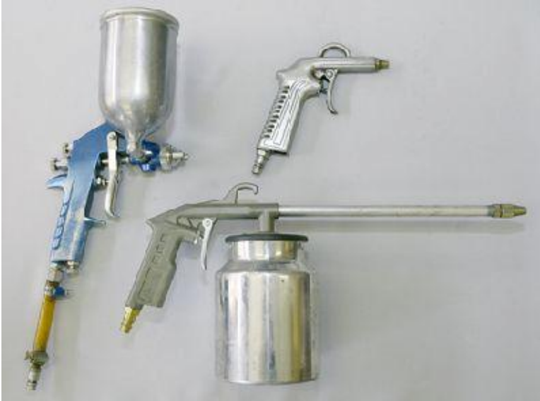
Figuur 14-14: Voor het gebruik van de verfspuit, het luchtpistool en de vloeistofspuit mag je geen olie-nevelaar plaatsen.
